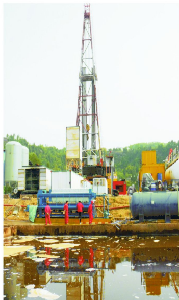
钻井污泥不落地处理系统（中石化四川广元苍溪气田）
