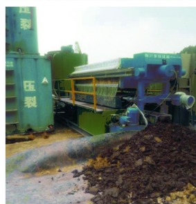
钻井污泥不落地处理系统（中石化四川广元苍溪气田）
